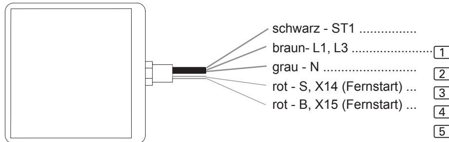
Die vormontierten Kabelschuhe je nach verwendeter Steuerung entfernen.
