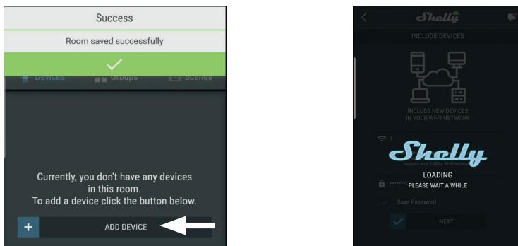
Siga as instruções no dispositivo (permitir acesso à localização, seleção da WLAN, introdução da palavra-passe, etc.). Os dispositivos (telemóvel e sistema de arranque remoto) têm de se encontrar na mesma rede.
