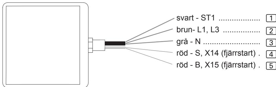
Ta bort de förmonterade kabelskorna i enlighet med den aktuella styrenheten.
