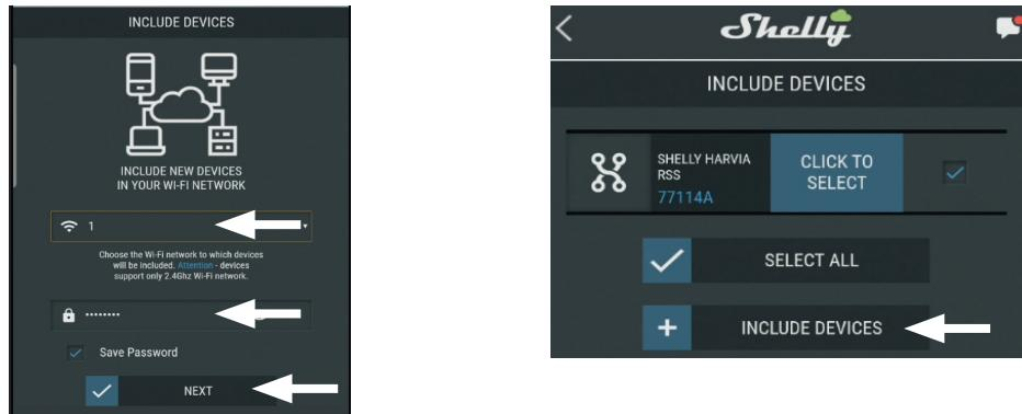
ACHTUNG: Dauert ca. 1 Minute ! -> Das Gerät wird angezeigt.
