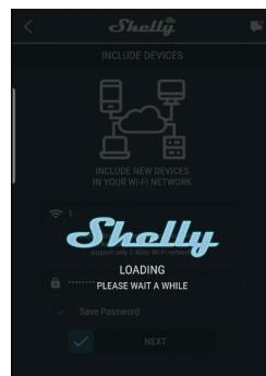
Suivez les instructions sur l'appareil (validation de l'accès au site, sélection de W-LAN, saisie du mot de passe, ...). Les appareils (téléphone mobile et système de mise en marche à distance) doivent se trouver dans le même réseau.
