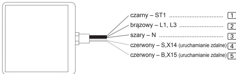
Zamontowane wstępnie końcówki kablowe należy usunąć odpowiednio do zastosowanego sterownika.
