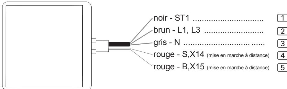
Retirez les cosses de câble prémontées en fonction de la commande utilisée.
